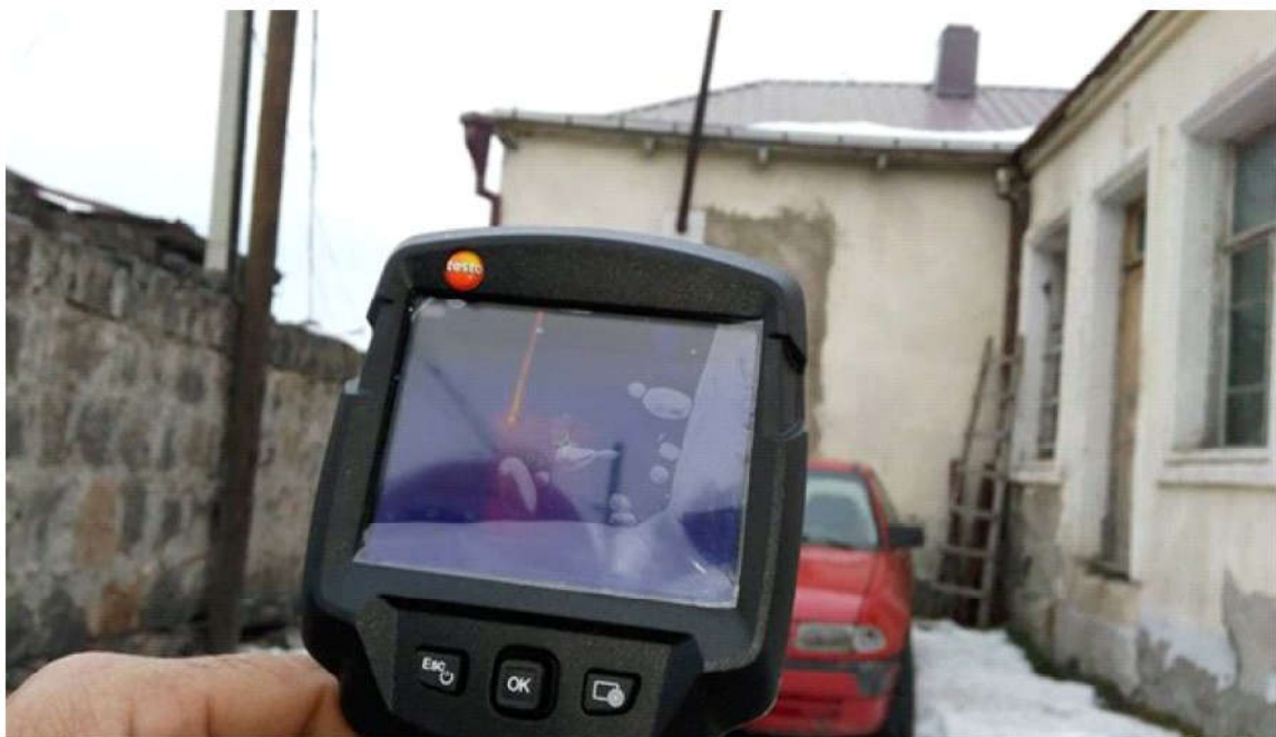
№2 საბავშვო ბაგა-ბაღი - /დანაკარგების განსაზღვრა ღუმელის საკვამურიდან, ამ ღუმელის მარგი ქმედების კოეფიციენტია 35-38%, დანარჩენი თბოდანაკარგია/
