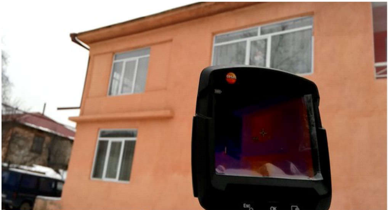
საბავშვო ბაღის თერმოსურათი კედლების დათბუნებამდე /დანაკარგები დიდია კედლებიდან/
